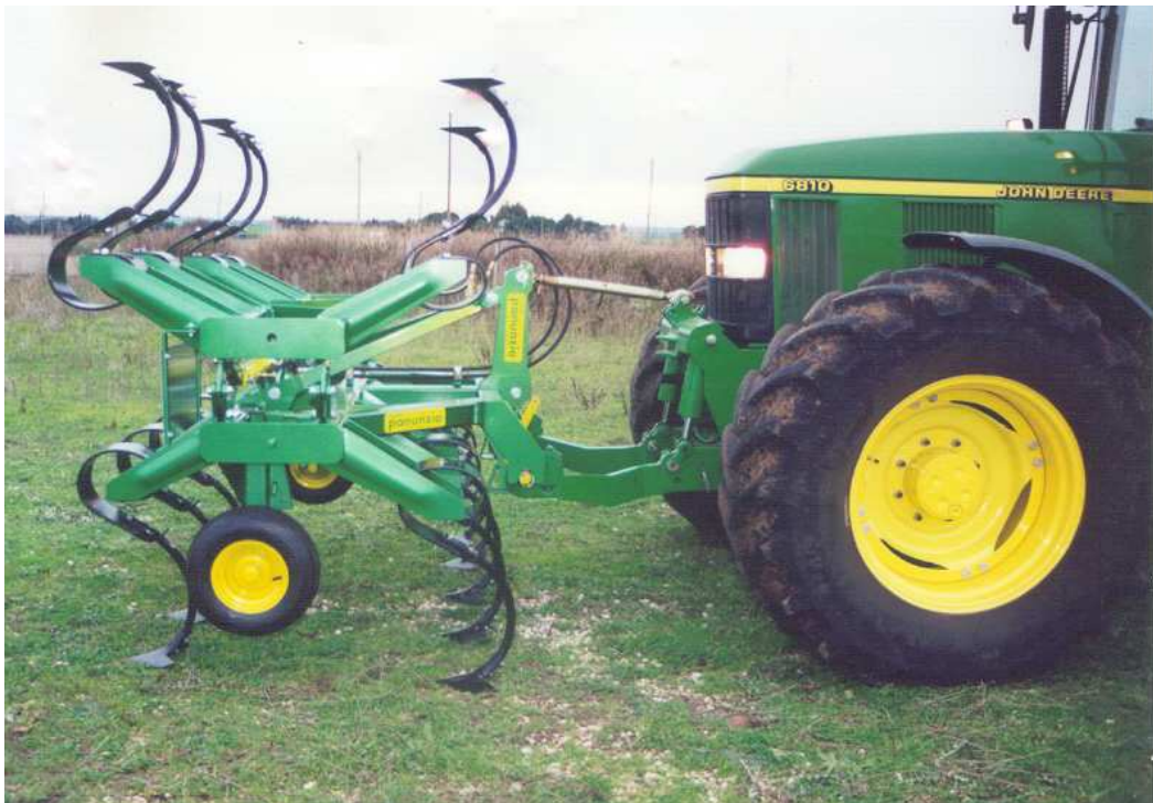
FIG. 5 - Vibropan – a 15 molle anteriore
