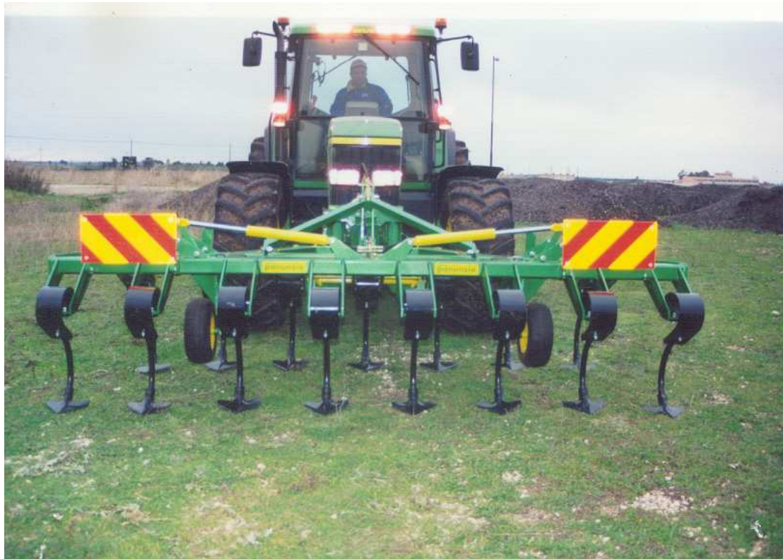
FIG. 2 - Vibropan – a 15 molle anteriore
