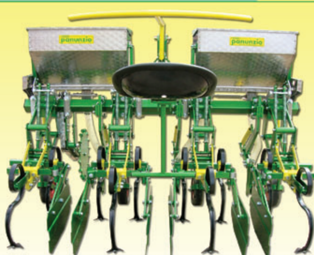
Concimatrice 3 file a cm. 60 per arachidi, con guida manuale, concimatore organico con trasmissione a ruotino dentato, interratori tipo ECO, elementi a molle vibranti, protezione piantine a lamiera, ruote gomma
