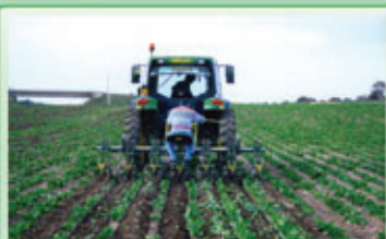
Sarchiatrice su campo di barbabietole da zucchero a 6 file a cm. 50 con guida manuale, dischi, vomeri da cm. 28 e ruote gomma
