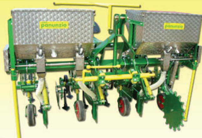
Concimatrice 3 file a cm. 60 per arachidi, con guida manuale, concimatore organico con trasmissione a ruotino dentato, interratori tipo ECO, elementi a molle vibranti, protezione piantine a lamiera, ruote gomma
