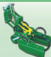
Elemento a 3 molle vibranti, lamiere di protezione piantine, ruota ferro Hoeing element with 3 vibrant springs, plant protection in sheet, iron wheel
