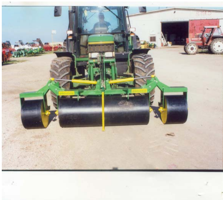
FIG. 8 – Rullopan six 45- 6 file a 45 cm. anteriormente al trattore
