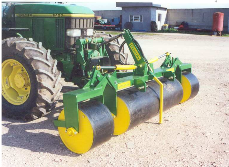
Fig. 4 – Rullopan five 50 a 5 file cm. 50 anteriormente al trattore
