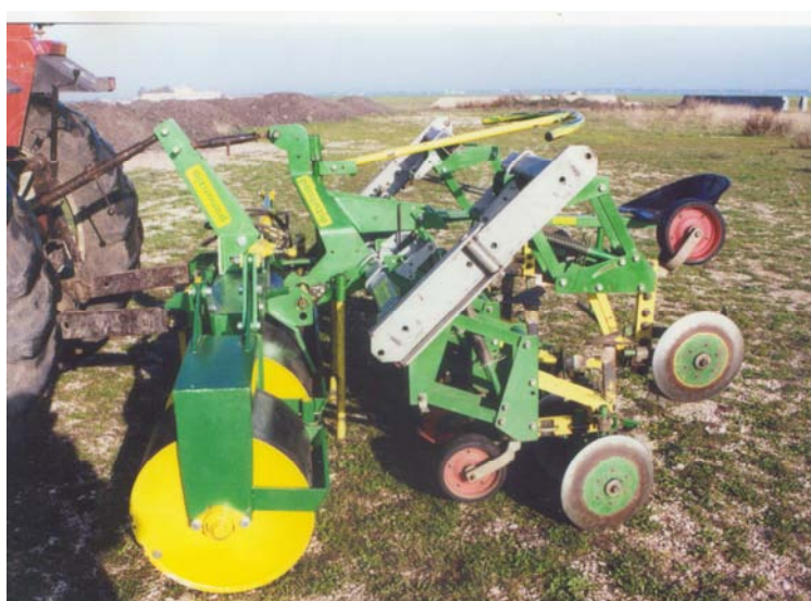
FIG. 7 – Rullopan six 50 - abbinato alla sarchiatrice
