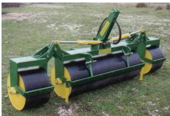
FIG. 1 - Rullopan six 45 - 6 file a cm. 45 con telaio reversibile e chiusura idraulica
