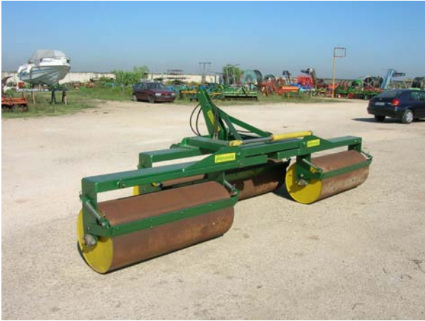
FIG. 9 – Rullopan master three 400 con chiusura idraulica
