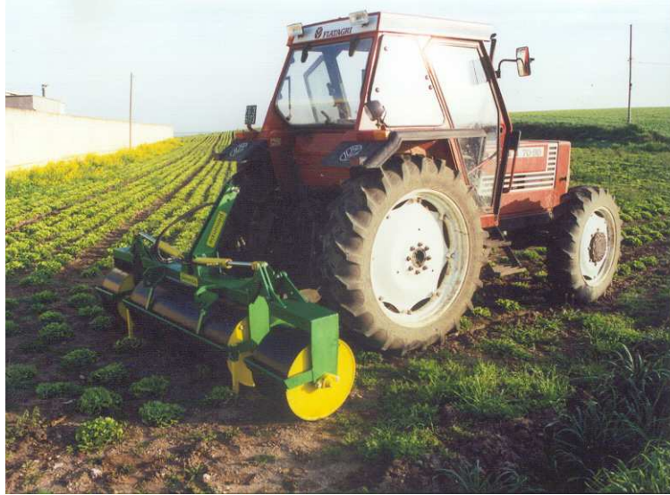
Fig. 5 – Rullopan six 45 - a 6 file cm. 45 posteriormente al trattore
