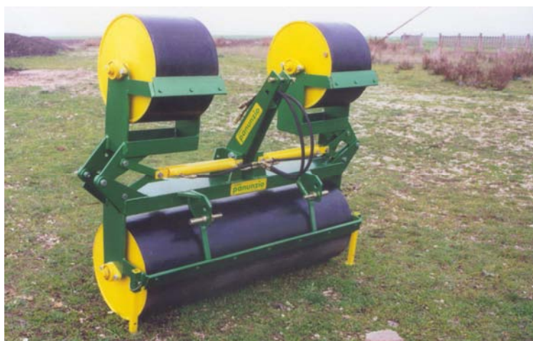
FIG. 6 – Rullopan six 50 - con chiusura idraulica per il trasporto su strada
