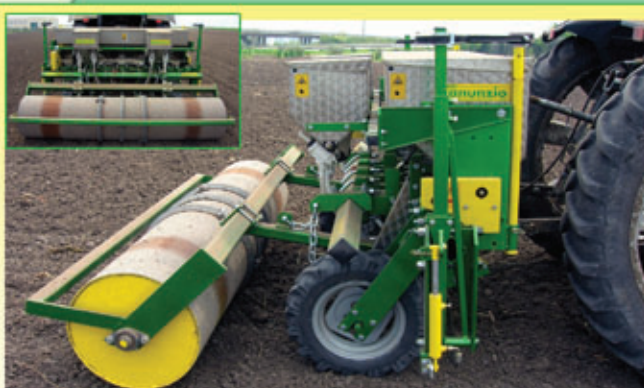
Insolcatrice a 2 bina, con concimatore chimico 200x48x51, 4 assolcatori ECO, microgranulatore a due cassette 33x38, ruote 6.5.80.13, segnalini idraulici e rullo diametro mm.508x 2400
