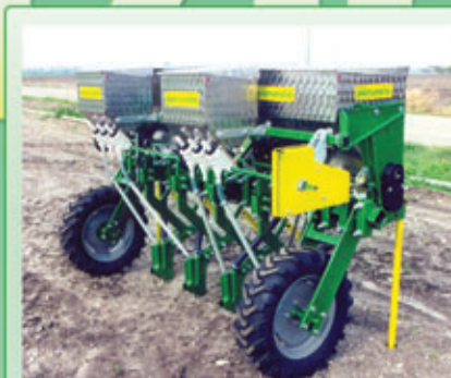
Insolcatrice a 4 file cm. 45 con concimatore chimico 200x48x51, 4 assolcatori ECO, microgranulatore a 2 cassetti 33x38, ruote 6.5.80.13
