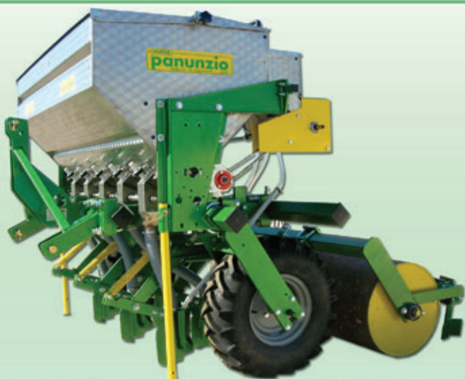
Insolcatrice a 4 file, con concimatore organico 200x80x70, 4 assolcatori ECO, microgranulatore a 2 cassette 33x38, ruote 7.00.12, rullo diametro mm.508 x 1800, 4 tracciatori posteriori al rullo
