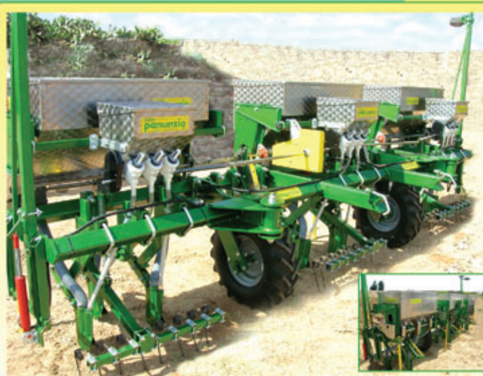
Insolcatrice a 3 bina, con 3 concimatori organici 100x48x51, 9 assolcatori ECO, microgranulatore a 3 cassette 33x38, segnalini idraulici, erpici posteriori, ruote 7.00.12, telaio chiudibile
