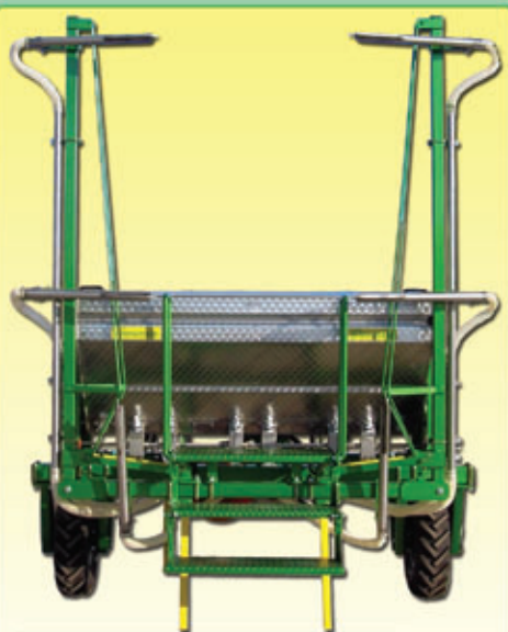
Scaletta per carico e manutenzione
